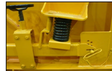
Slika: Nastavitev sejalnega kota
