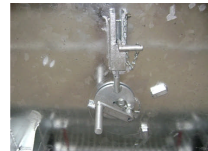
Slika. 2: Nastavitev sejalnega kota
