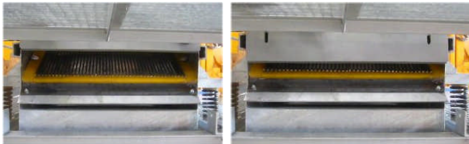
Slika 3: Višinsko nastavljiva zaščita na izhodu
