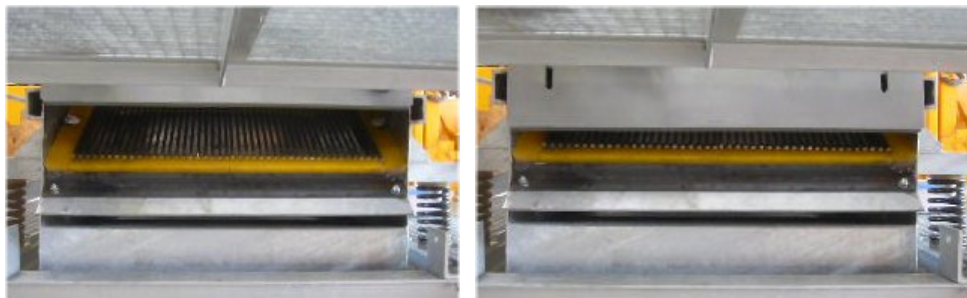
Abb. 3: Höhenverstellbares Wehr an Feststoff-Austragsöffnung
